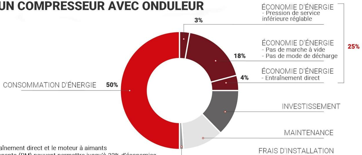
L'entraînement direct et le moteur à aimants permanents (PM) peuvent permettre jusqu'à 33% d'économies d'énergie et jusqu'à 25% d'économies sur le coût total de propriété.
